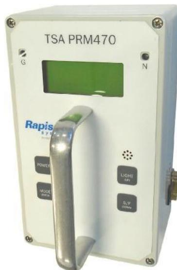
**個人用ハンドヘルド放射線モニターPRM470は、放射性物質の発生源や汚染された場所の特定、バックグラウンドの監視、強度の測定などを行います**
